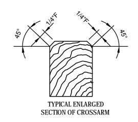
DETAIL 2 CROSSARM DRILLING GUIDE - TRANSMISSION
