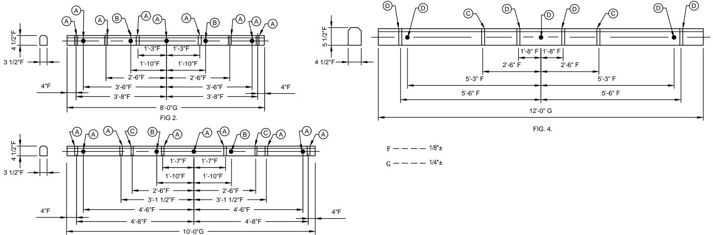
DETAIL 1 **CROSSARM DRILLING GUIDE - DISTRIBUTION**
